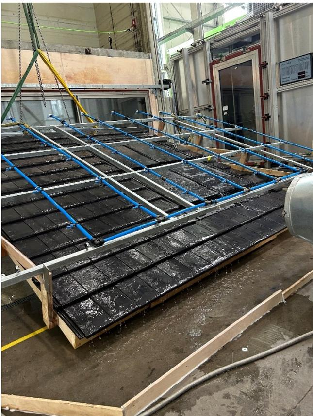
Bild 19: Prüfung bei 15°
