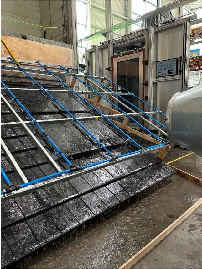
Bild 17: Prüfung bei 30°
