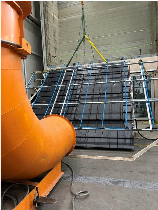
Bild 15: Prüfmusteransicht mit Windgenerator
